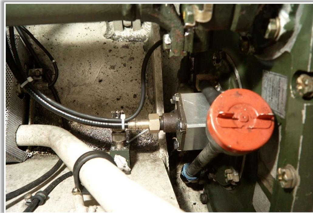
Der Signalgeber ist eine firmeneigene Entwicklung und wird zwischen dem Lenkausgleichsgetriebe und dem Anschlußflansch der Tachowelle montiert. Am Gehäuse befindet sich eine Gerätedose, zum Anschließen des Signal Verbindungskabels
