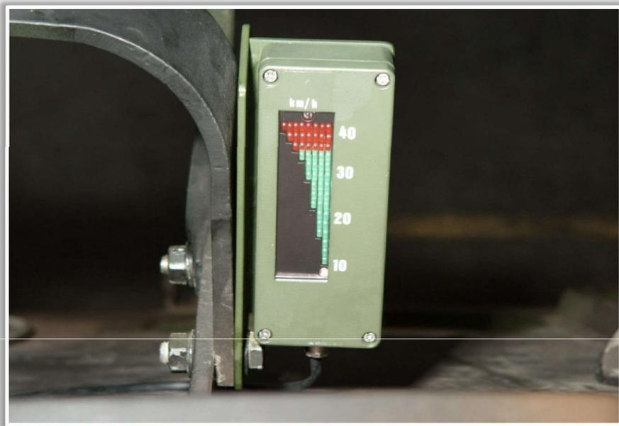
Die Geschwindigkeit wird mittels LED-Balken angezeigt. Je schneller gefahren wird, umso mehr grüne LEDs leuchten. Wird die Geschwindigkeitsgrenze erreicht, leuchten und blinken die roten LEDs. Durch eine Fozelle wird die Helligkeit geregelt. Sobald der Tarnlichtkreis eingeschaltet wird, erlischt die Anzeige komplett.
