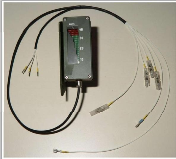
Anzeigeinheit mit komplettem Kabelsatz.
