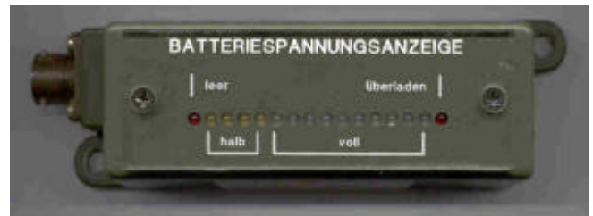
Anzeige mit Gehäuse Maße ca. 100x36x33 mm
